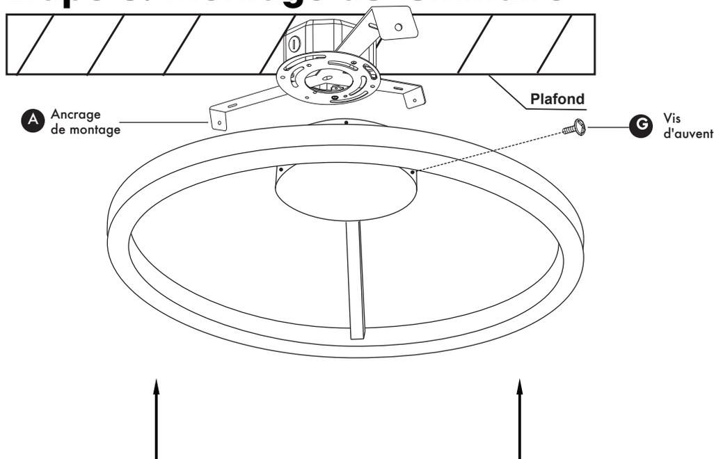
Fixez le luminaire au support de montage (A). Fixez le luminaire avec la vis du pavillon (G).
