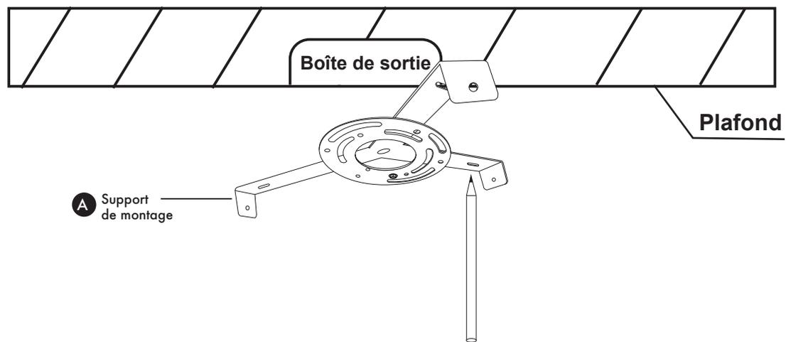
Retirez le support de montage (A) du luminaire. Soulevez le support de montage (A) jusqu'au plafond. Marquez l'emplacement des ancrages en plastique (B). Percez des trous pour les chevilles en plastique (B). Insérez les chevilles en plastique (B) dans le trou.
